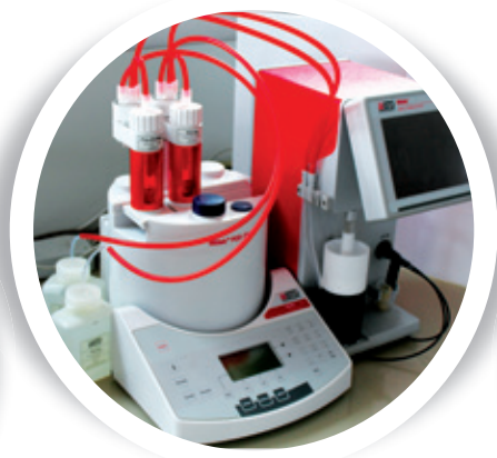
Zetamètre pour mesurer la charge des colloïdes (gélatine, dérivés de chitine)
