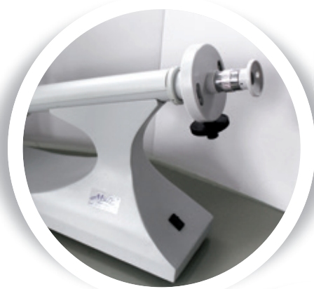
Polarimètre de Laurent permettant la mesure de l'activité optique des gommés arabiques (origine et pureté), de l'acide tartrique, etc...
