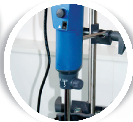
Ultra-Turax® permettant une très rapide dispersion d'un solide dans l'eau
